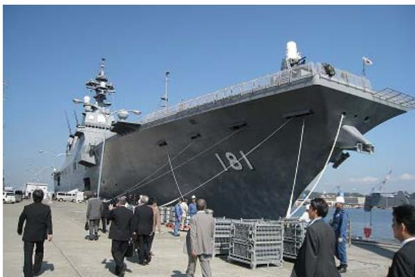
「ひゅうが」は、2009年3月18日に就役した、海上自衛隊初の全通甲板を有するヘリコプター搭載護衛艦です。全長197m、全幅33m、基準排水量13,500tの大型艦ですが、100,000馬力の機関により、速力30kt(55km/h)を誇ります。
