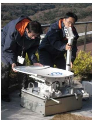
その後、講演の中で紹介された小型衛星通信地球局を構成する「可搬型アンテナ」と「車載型アンテナ」の実機デモを見学させていただきました。「可搬型アンテナ」は、自動車などで運搬できないような被災地に対しても、運用者が手で持ち運ぶことができるタイプのアンテナです。分割・組立式のアンテナ鏡面を採用しており、トランクに収容して運搬できます。組立、収容には工具を使う必要は一切ありません。また、GPS センサと磁気方位計を用いて衛星を自動捕捉できるようになっていますので、設営者は特殊なスキルを有する必要がなく、15分程度の時間で機材をセッティングし、回線を開通させることができます。
