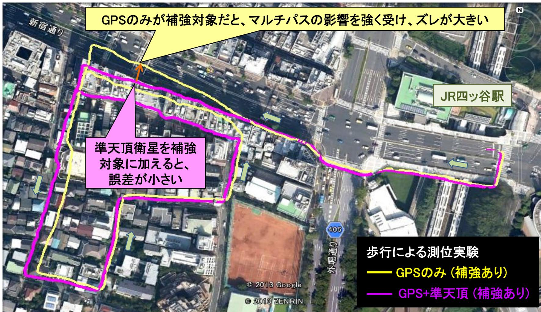
(注) 準天頂衛星初号機を利用した測位受信機タイプ I 評価機による実証結果
