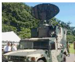
衛星単一通信可搬局装置
