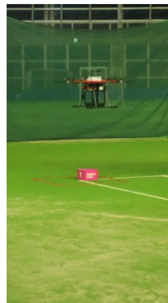
準天頂衛星システムを ドローンの自律飛行制御 に活用し、物流分野での ピンポイント配送を想定 した実証実験
